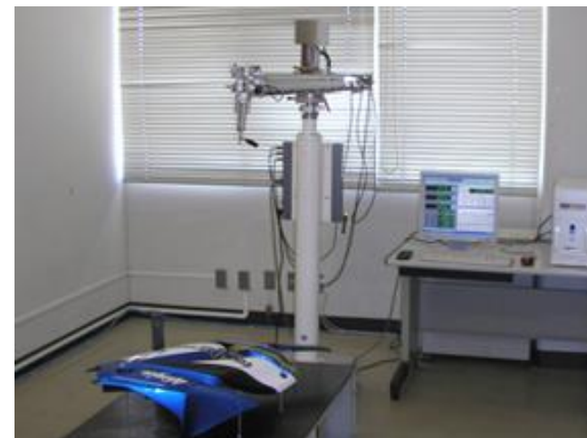
ワイヤ式3次元形状測定機
