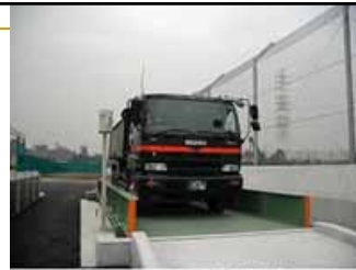
トラックスケール(計量所)
