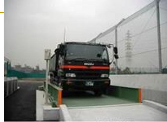
トラックスケール(計量所)
