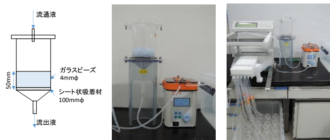
図3 吸着試験装置概要
